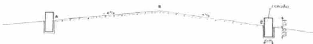
Figura 4 - Colocação do cordão
